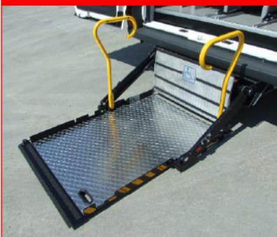
Il sistema sotto pianale esterno, rispetto a pedane interne, offre maggiore spaziosità nel vano passeggeri per la locazione di bagagli ed invisibilità interna del sistema di risalita dei disabili - impossibile la locazione della ruota di scorta
