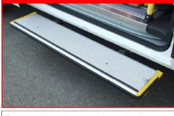
Dotato di movimentazione elettrica automatica, sotto illuminato con spia a cruscotto e tasto per disinserimento, offre dimensioni utili di 1200x260 mm
