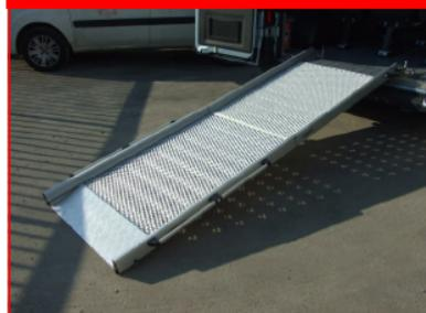
La rampa in lega di alluminio apribile con portata fino a 400KG, è dotata di un pratico sistema "fast lock" che ne consente il facile smontaggio dal veicolo se non utilizzata; le dimensioni possono variare in funzione della rampa scelta e comunque comprese tra 2500 x 840 e 2600 x 900mm
