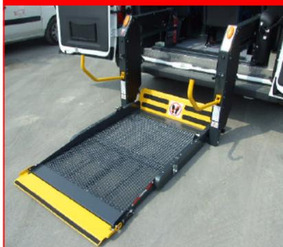
Per Safety Bus sono disponibili pedane di diversa misura e portata, tutte accumulate da movimentazioni completamente automatiche e con sistema di impacchettamento interno "a libro"
